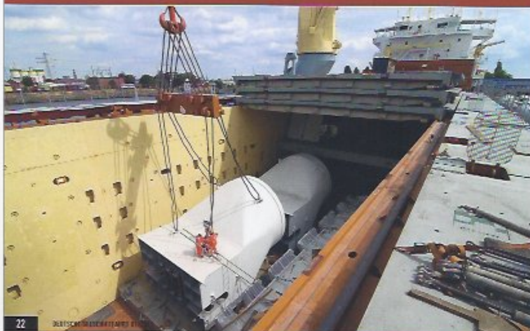
OPEN AIR: Die Luke des riesigen Laderaums kann bei den neuen SAL-Schwer-gulfrachtern während der Fahrt geöffnet bleiben.
