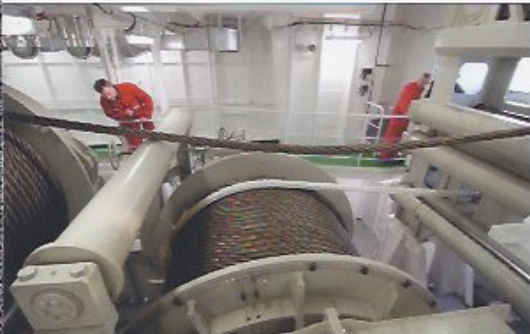
WINDE: Mit 200 Tonnen Zugkraft ist die „Nordic“ das leistungsfähigste Spezialschiff der gesamten deutschen Havarieflotte.
