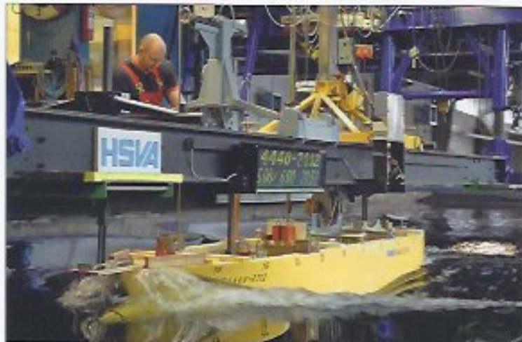
DESIGN: An der Hamburgischen Schiffbau-Versuchsanstalt wurden die Rumpfallernativen für die Schlepper ausführlich getestet.
