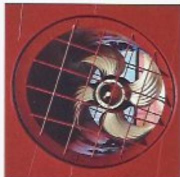
**MANÖVRIERHILFE:** Das Bugstrahlruder mit einer Leistung von 1.200 kW.
