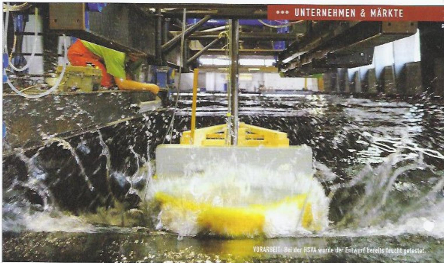
VORARBEIT: Bei der HSVA wurde der Entwurf bereits feucht getestet.
