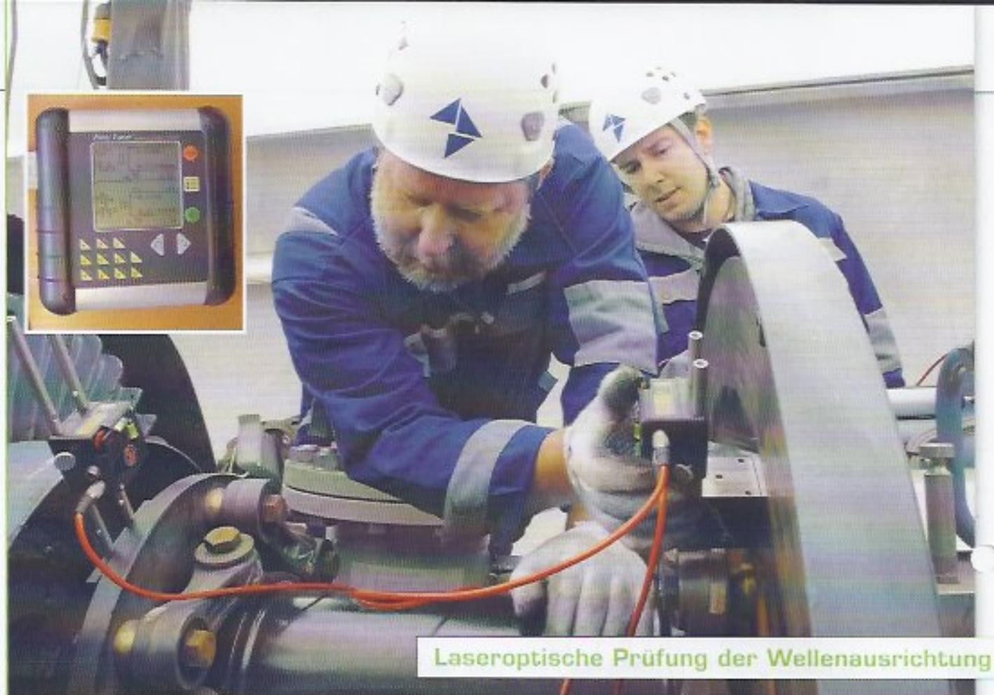
**Wellengang:** Ein laseroptisches Prüfgerätes wird am Triebstrang einer AN-BONUS-Anlage eingerichtet, die Messwerte werden übertragen.
