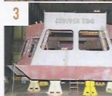
**1. SKELETT:** Erste Arbeiten für das Zusammensetzen des Doppelbodens. Schiffbauer fügen hier das aus Längs- und Querversteifungen bestehende Skelett zusammen.
